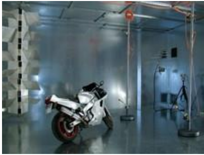
Abbildung 1: Modenverwirbelungskammer an der OVGU. Quelle: nepit.eu
