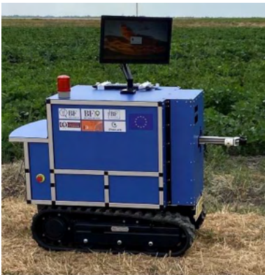
Abbildung 1: Innovatives Agri-PET/MRI Gerät zur Messung von frühem Wasser- und Nährstoffmangel in der Agrarkultur. Quelle: Agri-PET/MRI
